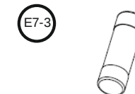
fuse 5x20 Sicherung 5x20 T2A ... 90-0-0-9038-0 T8A ... 90-0-0-9040-0
